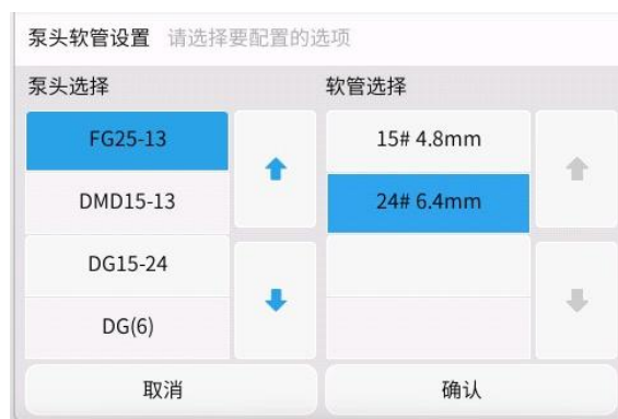
图 12 泵头软管设置
