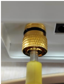
接地方式二：插接直径4mm的测试插头
