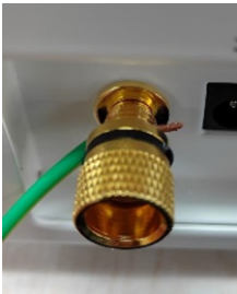
接地方式一：直接压接金属导线
