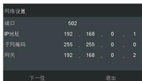
DHCP功能不启用时，可手动进行网络参数设置，通过下一位进行参数切换，通过上下按键进行参数调整。
